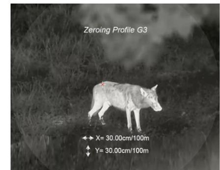
appuyez brièvement ou longuement sur le bouton **Haut / Bas / Caméra / Menu** pour déplacer la position de l'image infrarouge jusqu'à ce que la cible sur l'image infrarouge soit alignée avec le centre du réticule de la lunette de visée diurne.
